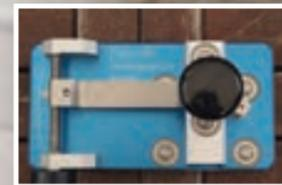
*Mit Hilfe dieser speziellen Vorrichtung werden die Schienen exakt an den möglichen Kreisdurchmesser der Glöckchenpyramide angepasst.*
